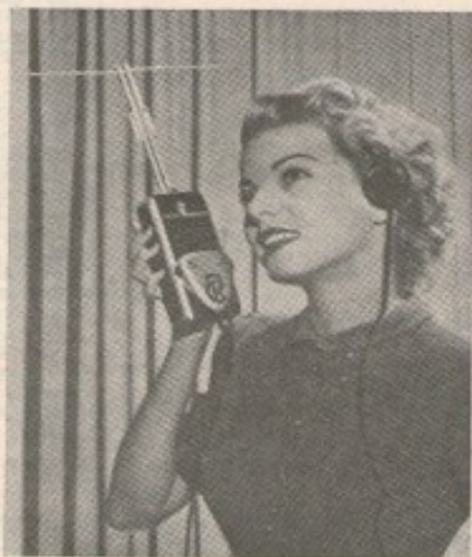
Fig. 8.11. - Apparecchio « parla e ascolta » portatile a mano del tipo citizen. Funziona sulla banda dei 64 centimetri.
